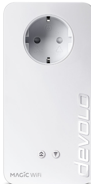
Afb. 2: devolo Magic 2 WiFi 6 met specifieke stekker en stopcontact
